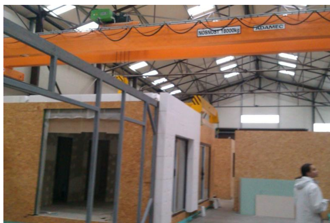
Obr. 11: Jeřáb, kterým se přenášejí buňky [5]
