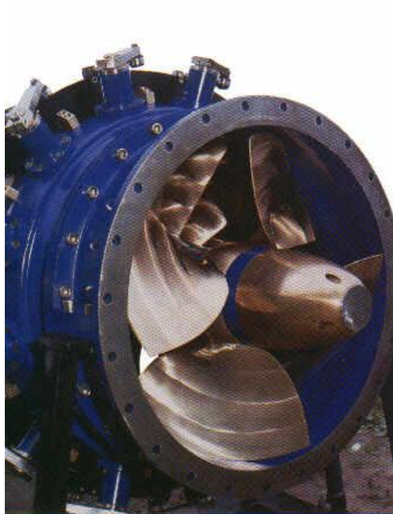
Obr. 13: Semi-Kaplanova turbína – výrobek firmy Hydrohrom, instalovaná ve výše zmíněné MVE
